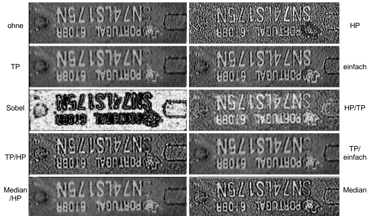
Abbildung 3.5: Ergebnisse verschiedener Filterverfahren. Nur der Hochpaß- und einfache Ableitungsfilter trennen das Firmenlogo und das „S“. Bei allen anderen Filtern sind diese verklebt. Die rote Markierung ist der Umriss einer als zusammengehörig gefundenen Punktmenge.
