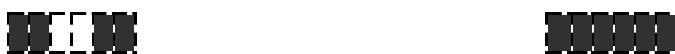
Abbildung 3.1: Spaltauffüllung durch Sobelfilter. Schwarze Punkte = 1, weiße Punkte = 0. Links: Ausgangsbild; Rechts: Bild nach der Filterung
