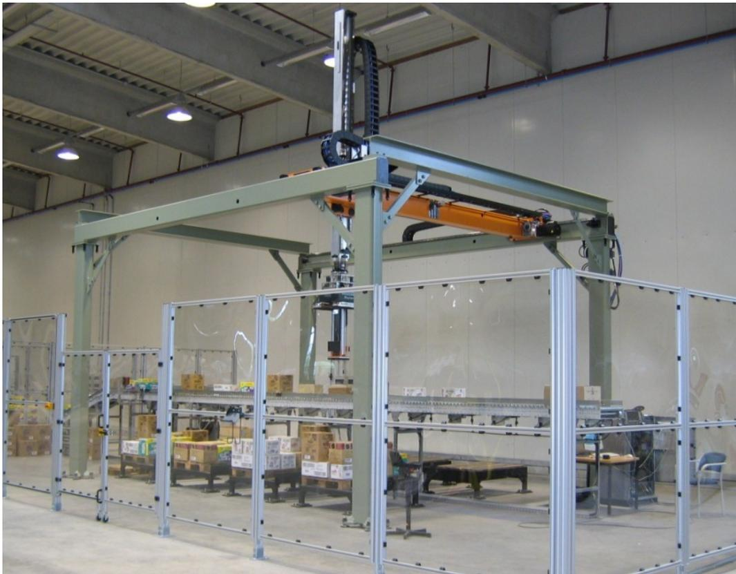
Abbildung 2.1: Roboter-Palettieranlage
