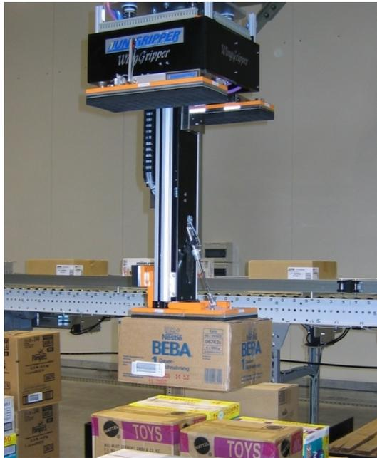
Abbildung 2.2: Sauggreifer zum Roboterpalettieren
