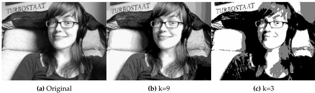
Abbildung 2.7: Segmentierung eines Bildes mit Hilfe von KMEANS in k viele Farbgruppen
